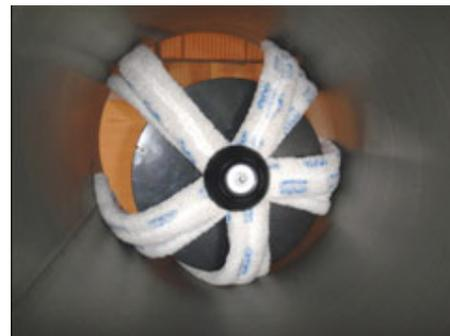
Abbildung 15 und 16: „Spider Mob“ zur Feuchtreinigung, Quelle: Boesch Mess- und Reinigungssysteme
