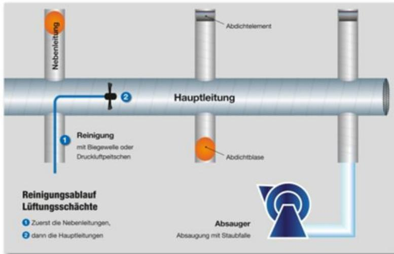
Abbildung 6: Prinzipschema einer Bürstenreinigung, Quelle: breg-rauchfangkehrer.at
